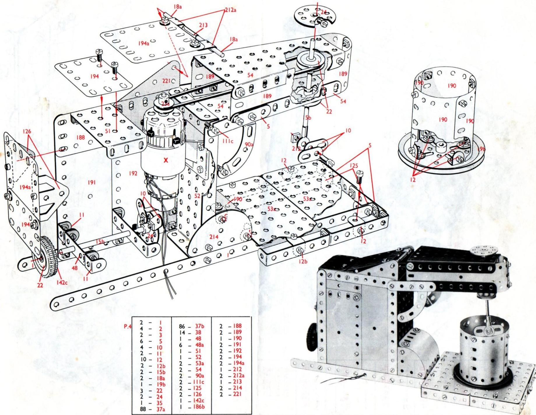
**P.5. Pile Driver/Pfahlramme/Appareil à enfoncer les Pieux/Martinete de pilotes/Battipalo/Heimachine/Pálkran**
