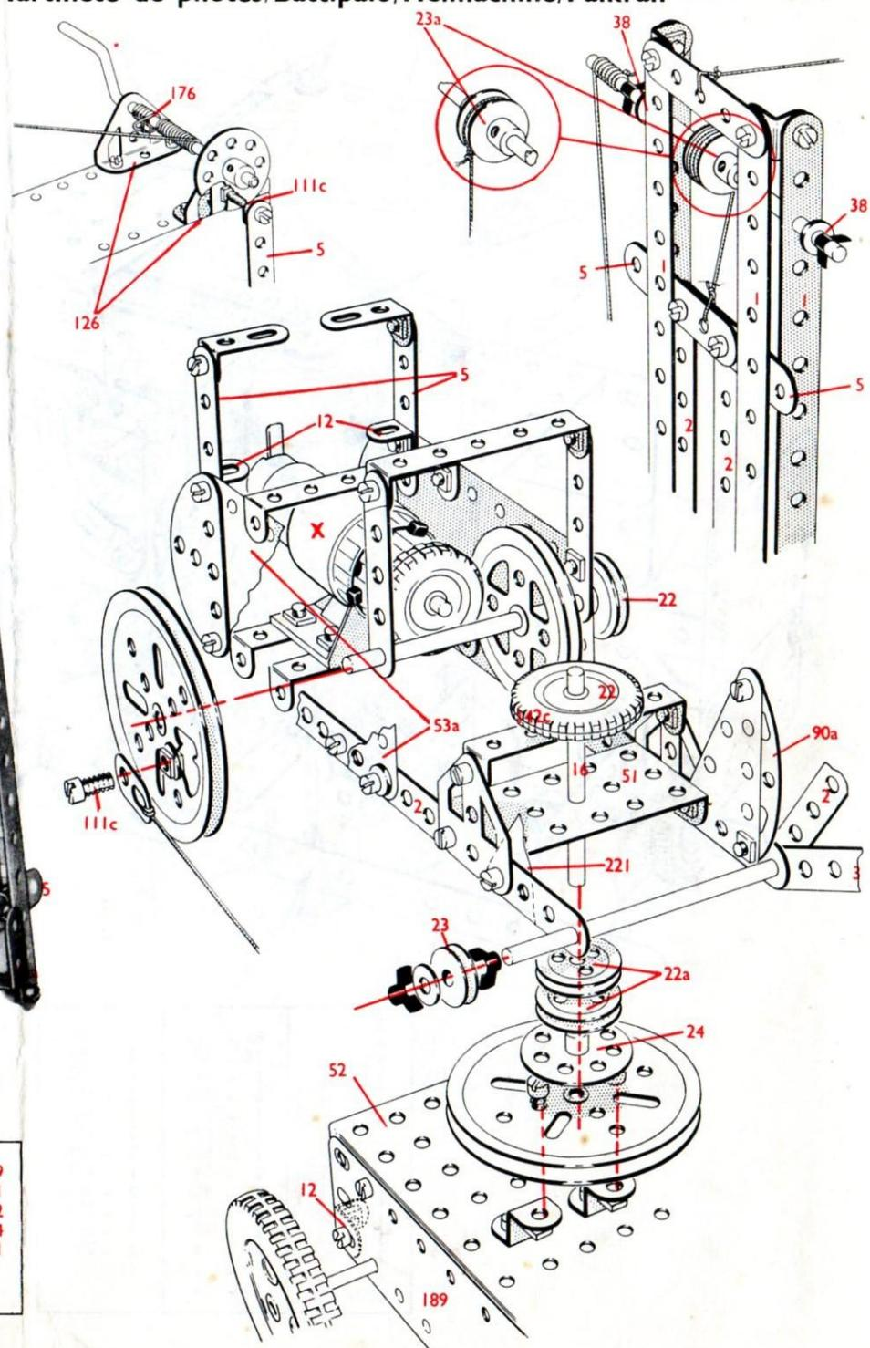
**P.6.** Windmill/Moulin à vent/Windmolen/Windmühle/Molino a Vento/Molino de viento/Väderkran
