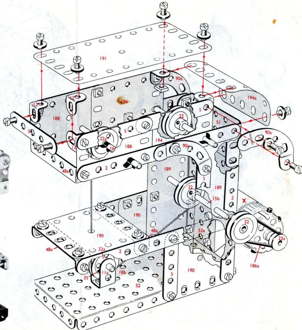
**P.14. Traction Engine/Dampftraktor/Moteur de Traction/Máquina de tracción/Trattore/Tractiemotor/Lokomobil**
