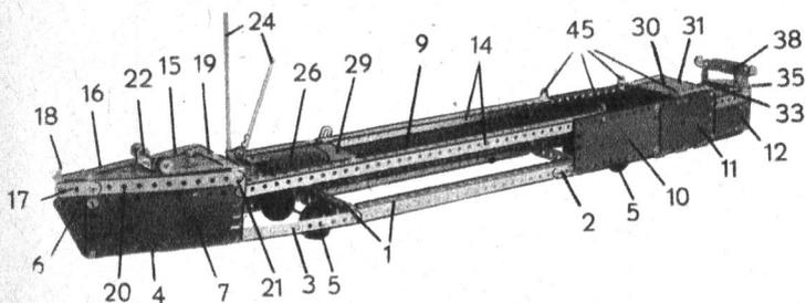
de deux bandes de 5 trous (4) raccordées au trou trois. Les roues (5) formées avec les poulies 22 munies de pneus sont placées pour l'avant au trou trois en partant du cadre, pour l'arrière au trou neuf de la bande. Les plaques sont montées le long de la coque en partant de l'avant :
