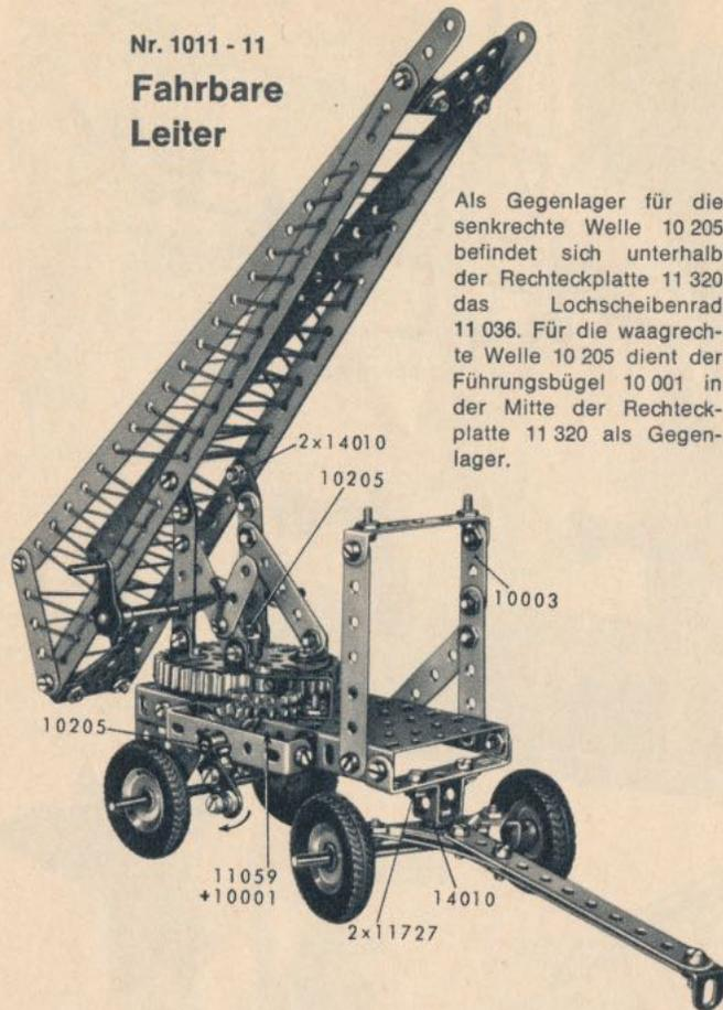
Als Gegenlager für die senkrechte Welle 10 205 befindet sich unterhalb der Rechteckplatte 11 320 das Lochscheibenrad 11 036. Für die waagrechte Welle 10 205 dient der Führungsbügel 10 001 in der Mitte der Rechteckplatte 11 320 als Gegenlager.
