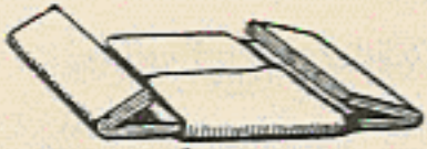
Fig. 22. Kondensator in Wachspapier ein- geschlagen.
