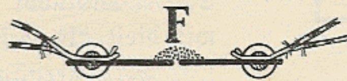
Fig. 75. Fritter mit den Metallspänen F.
