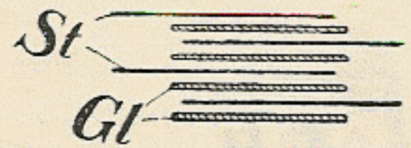
Fig. 21. Reihenfolge der Belege mit Glimmer- und Stanniol- (Aluminium-) platten. Es sind erst 4 Be- lege aufgeschichtet.
