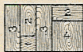
447/4. Der Boden des Aufzugskastens.
