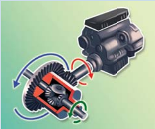
Das Ritzel überträgt die Kraft des Motors an das Differentialgetriebe und somit an die Achswellen.
