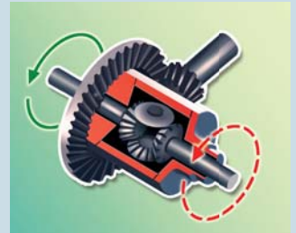
Dank des Differentialgetriebes drehen sich die Räder eines Fahrzeugs unterschiedlich schnell.
