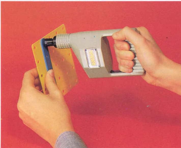
3) Mettre les trous des pièces à assembler face à face poignée serrée enfile le rivet.
