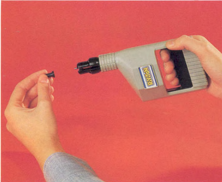
1) Enfiler bien à fond le rivet sur l'axe métallique.
