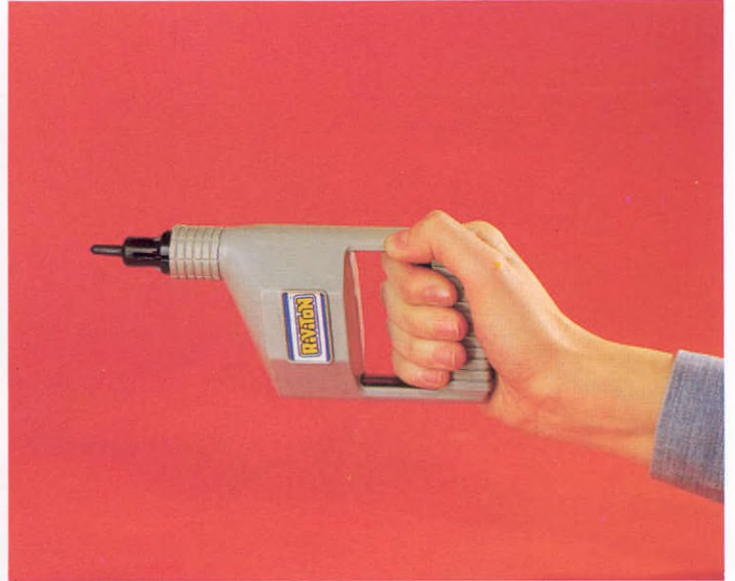
2) Serrer la poignée de l'outil le rivet s'étire sur l'axe.
